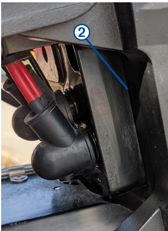
Motor sem a vedação instalada
