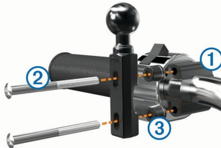
**OBSERVAÇÃO:** ambos os parafusos de 1/4 pol. padrão e M6 estão inclusos. Faça a correspondência de tamanho dos parafusos originais do suporte da braçadeira de câmbio e freio.
