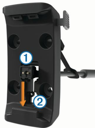
2 将电源线下滑至开口 ② 底部，然后拉动电源线，直至其靠近开口位置。
