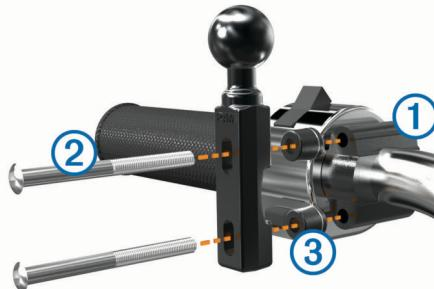
**ПРИМЕЧАНИЕ.** в комплект входят стандартные болты 1/4 дюйма и болты M6. Подберите болты размера заводских болтов на кронштейне зажима сцепления или тормоза.
