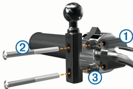
**注:** 1/4 in. 標準ボルトと M6 ボルトの両方が付属しています。クラッチクランプまたはブレーキクランプブラケットの工場で取り付けられた 2 本のボルトのサイズを合わせます。
