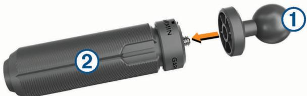
**NOTA:** è necessario stringere il supporto a sfera del cavalletto in modo che non si muova durante l'uso. Il supporto a sfera del cavalletto utilizza una filettatura da 1/4"-20 ed è compatibile con la maggior parte dei cavalletti. Per prestazioni ottimali, non sollevare il dispositivo oltre l'altezza della vita o un'altezza totale di 1,2 m (4 piedi).
