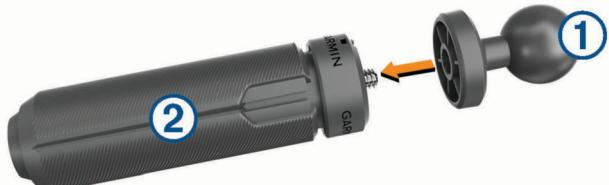
**REMARQUE :** vous devez serrer la rotule du trépied pour qu'elle ne bouge pas pendant l'utilisation. La rotule du trépied utilise un filetage de 1/4"-20 et est compatible avec la plupart des trépieds. Pour des performances optimales, ne soulevez pas l'appareil au-dessus de la taille ou d'une hauteur totale de 1,2 m (4 pi).
