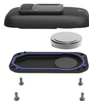
4 Coloque a nova bateria com o lado negativo virado para o interior da tampa frontal.
