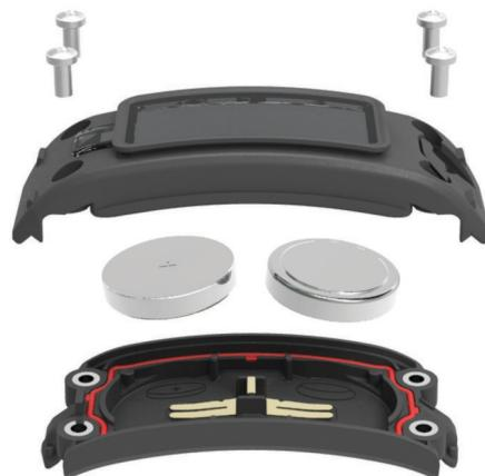
4 Applicare un sottile strato di vaselina filante sui due lati delle nuove batterie utilizzando un cotton fioc.
