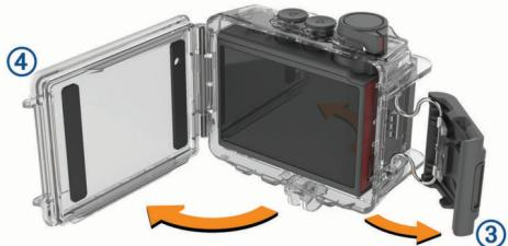
4 Öffnen Sie die Kameragehäuseabdeckung ④.
