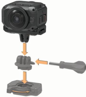
**HINWEIS:** Bei einigen Halterungen aus dem Zubehörangebot wird evtl. eine andere Methode zum Sichern der Kamera an der Halterung verwendet. Weitere Informationen finden Sie in den Anweisungen aus dem Lieferumfang der Halterung aus dem Zubehörangebot.
