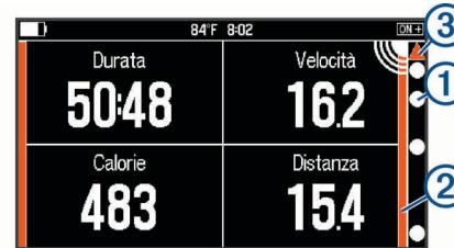
Il LED di posizione del veicolo ① si sposta in alto sulla barra di stato ② quando un veicolo si avvicina alla bici. Il LED del livello di pericolo ③ e la colonna ② cambiano colore in base al potenziale livello di pericolo. Il verde indica nessun veicolo è rilevato. Arancione indica un veicolo in avvicinamento. Rosso indica che un veicolo sta avanzando ad alta velocità. Il dispositivo Varia Vision emette una vibrazione quando cambia il livello di pericolo.
