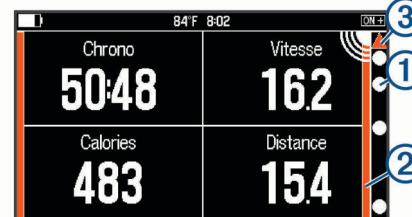
Le voyant DEL de position du véhicule ① progresse dans la barre d'état DEL cible ② à mesure qu'un véhicule se rapproche de votre vélo. Le voyant DEL de niveau de menace ③ et la colonne ② changent de couleur selon le niveau potentiel de menace. Le vert indique qu'aucun véhicule n'est détecté. L'orange indique qu'un véhicule est en approche. Le rouge indique qu'un véhicule roulant très vite se rapproche de vous. L'appareil Varia Vision vibre lorsque le niveau de menace change.
