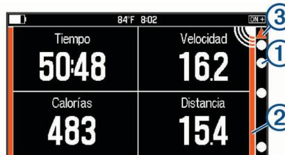
El LED de posición del vehículo ① se desplaza hacia arriba por la barra de estado de objetivo ② a medida que un vehículo se acerca a tu bicicleta. El LED ③ y la columna ② de nivel de amenaza cambian de color en función del posible nivel de amenaza. El color verde indica que no se ha detectado ningún vehículo. El color ámbar indica que se acerca un vehículo. El color rojo indica que un vehículo avanza a una velocidad alta. El dispositivo Varia Vision vibra cuando cambia el nivel de amenaza.
