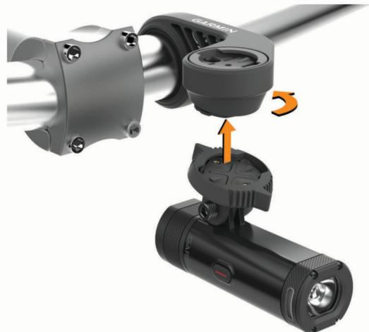
**12** Réglez l'angle du feu avant pour qu'il soit parallèle à la route et utilisez la clé Allen de 4 mm pour serrer la vis.
