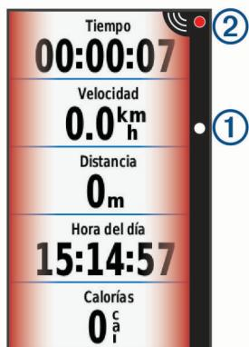
El LED de posición de vehículos ① sube por la columna según el vehículo se va acercando a tu bicicleta. El LED de nivel de amenaza ② cambia de color según el nivel potencial de amenaza. El color verde indica que no se ha detectado ningún vehículo. El color ámbar indica que se acerca un vehículo. El color rojo indica que un vehículo avanza a una velocidad alta.
