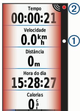
O LED de posição do veículo ① sobe na coluna à medida que um veículo se aproxima da bicicleta. O LED de nível de ameaça ② muda de cor com base no nível potencial de ameaça. A cor verde indica que não é detetado nenhum veículo. A cor âmbar indica a aproximação de um veículo. A cor vermelha indica que um veículo avança a uma velocidade muito elevada.
