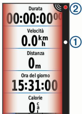
Il LED di posizione del veicolo ① si illumina mano a mano che un veicolo si avvicina alla bici. Il LED del livello di pericolo ② cambia colore in base al potenziale livello di pericolo. Il verde indica nessun veicolo è rilevato. Ambra indica un veicolo in avvicinamento. Rosso indica che un veicolo sta avanzando ad alta velocità.
