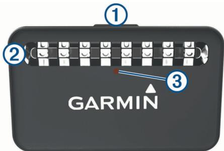
Los LED del faro trasero ② se encienden horizontalmente para indicar el nivel de batería. El LED de estado ③ muestra información adicional del dispositivo.
