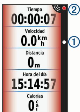
El LED de posición de vehículos ① sube por la columna según el vehículo se va acercando a tu bicicleta. El LED de nivel de amenaza ② cambia de color según el nivel potencial de amenaza. El color verde indica que no se ha detectado ningún vehículo. El color ambar indica que se acerca un vehículo. El color rojo indica que un vehículo avanza a una velocidad alta.
