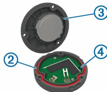
**7** Substitua a tampa posterior, alinhando a extremidade **3** com o orifício correspondente na placa de circuitos **4**.
