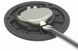
**5** Instale a nova pilha na tampa posterior com o polo positivo virado para baixo.
