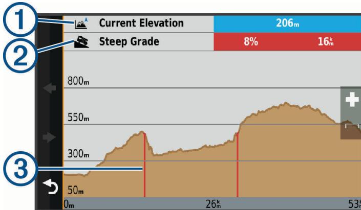
El dispositivo muestra la altura actual ①, la distancia a la siguiente pendiente pronunciada ② y un gráfico de la altura sobre la distancia. Las pendientes pronunciadas ③ se resaltan en rojo en el gráfico.
