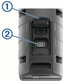
2 Branchez la petite extrémité du câble USB sur le port mini-USB ② de l'appareil.
