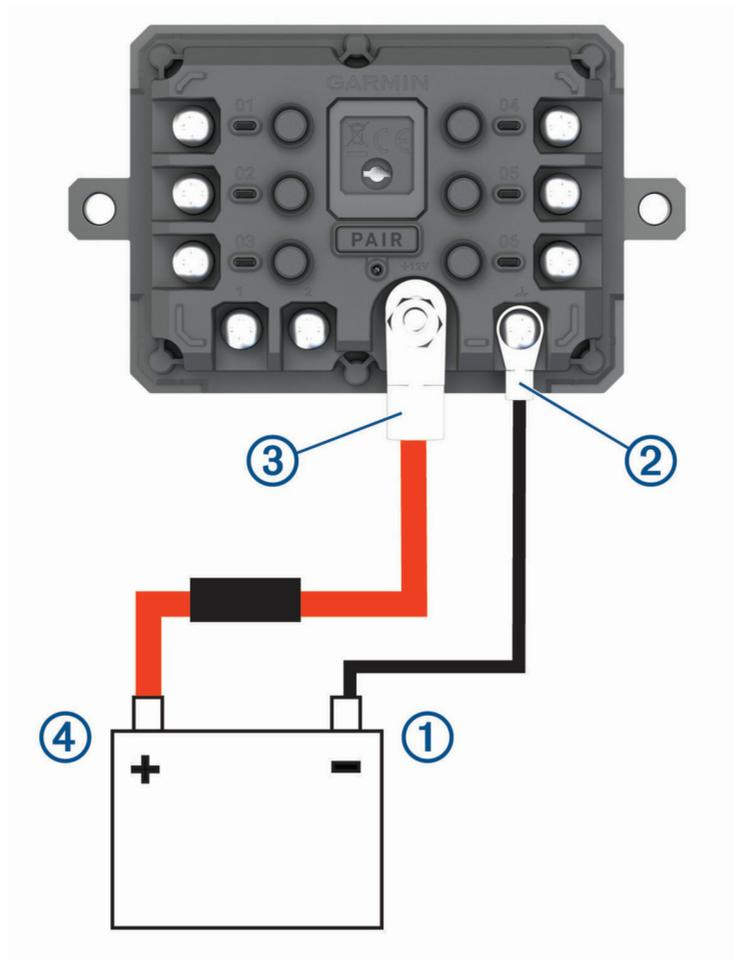
2 Collegare l'altra estremità del cavo di terra al terminale **GND** ② sul dispositivo.
