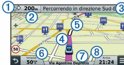
Le indicazioni relative alla svolta o all'uscita successiva o altre azioni vengono visualizzate nella parte superiore della mappa. Il simbolo ① indica il tipo di azione e la corsia o le corsie da percorrere, se disponibili. Il dispositivo visualizza anche la distanza dall'azione successiva ② e il nome della via o dell'uscita associata a tale azione ③.
