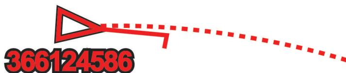
當已啟用 AIS 的目標提供了真實航向和航行方向資訊，但未提供轉彎率資訊時，目標的預計路線是根據對地航向資訊而計算得到。
