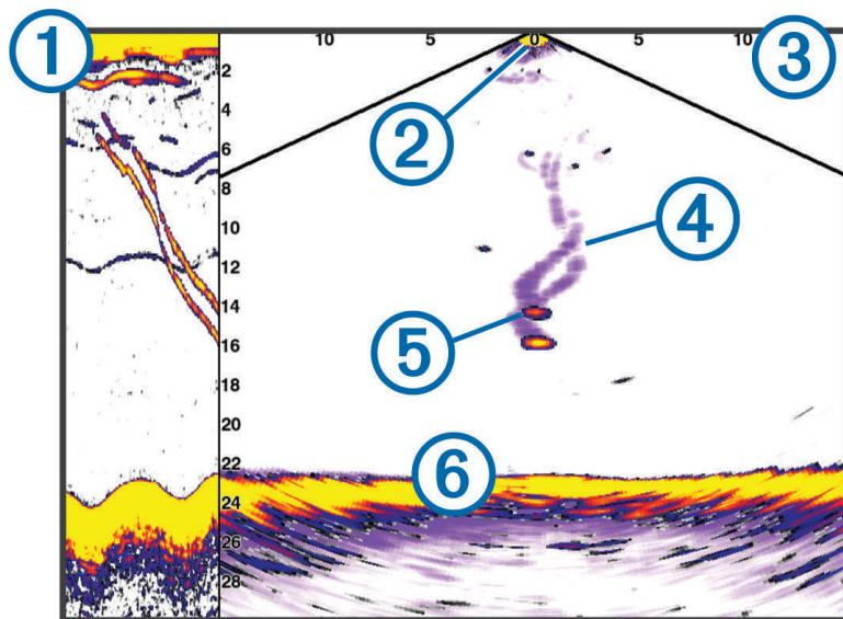
① Panoptix 底下檢視歷程 (在不斷捲動的聲納檢視中)
