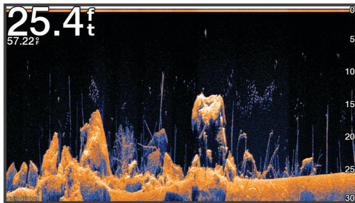
傳統探頭會發射圓錐形聲束。Garmin ClearVü 掃描式聲納技術會發射兩道狹窄的聲束，類似於影印機中的光束形狀。這些聲束可提供更清楚、如同圖片般的船下事物影像。
