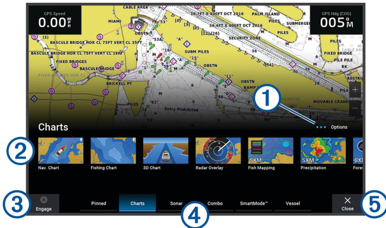
① Кнопка параметров, которая позволяет изменять порядок категорий и добавлять функции в категорию Закрепл.. Также обеспечивает доступ к Настройкам настройкам системы.
