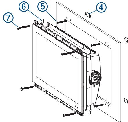
16 通过将随附的 M3 螺丝 ⑤ 穿入较小的 3.6 毫米 ( $9/64$  英寸) 孔并拧紧，使托板螺母固定到安装表面。
