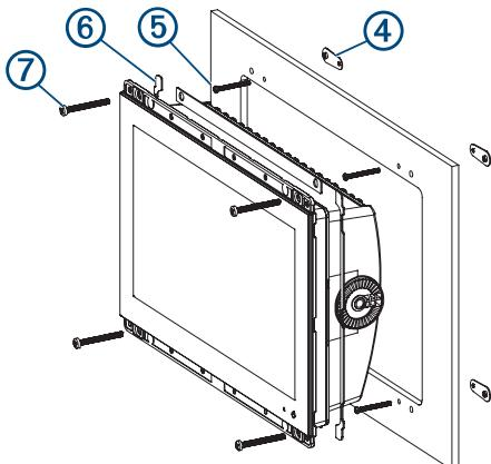
**16** Fixez la platine à la surface de montage en insérant une vis M3 fournie **⑤** dans le trou de 3,6 mm ( $\frac{9}{64}$  po).
