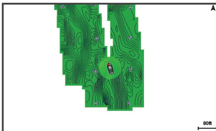
绿色圆圈指示良好的深度和 GPS 位置, 以及低于 16 km/h (10 mph) 的速度。黄色圆圈指示良好的深度和 GPS 位置, 以及 16 和 32 km/h (10 和 20 mph) 之间的速度。红色圆圈指示较差的深度或 GPS 位置, 以及高于 32 km/h (20 mph) 的速度。
