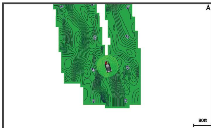
녹색 원은 수심과 GPS 위치가 양호함을 나타내며 속도가 16km/h(10mph) 미만임을 나타냅니다. 노란색 원은 수심과 GPS 위치가 양호함을 나타내며 속도가 16~32km/h(10~20mph)임을 나타냅니다. 빨간색 원은 수심과 GPS 위치가 불량함을 나타내며 속도가 32km/h(20mph) 초과임을 나타냅니다.
