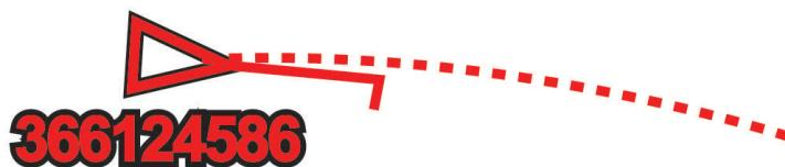
Quando i dati di COG e direzione vengono forniti da un target AIS attivato, ma non vengono forniti dati sulla velocità di svolta, la rotta proiettata del target viene calcolata in base alla COG.
