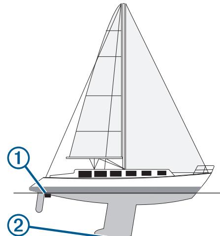
2 Velg Innstillinger > Mitt fartøy > Dybde og ankring > Forskyvning kjøl.
