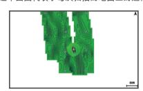
绿色圆圈指示良好的深度和 GPS 位置,以及低于 16 km/h (10 mph) 的速度。 黄色圆圈指示良好的深度和 GPS 位置,以及 16 和 32 km/h(10 和 20 mph)之间的速度。 红色圆圈指示较差的深度或 GPS 位置,以及高于 32 km/h (20 mph) 的速度。
