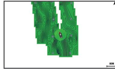
Um círculo verde indica uma boa profundidade e posição de GPS, e uma velocidade inferior a 16 km/h (10 mph). Um círculo amarelo indica uma boa profundidade e posição de GPS, e uma velocidade entre 16 e 32 km/h (10 e 20 mph). Um círculo vermelho indica pouca profundidade ou posição de GPS, e uma velocidade superior a 32 km/h (20 mph).
