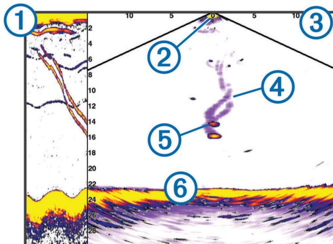
① Хронологические данные сонара Panoptix нижнего обзора в прокручиваемом режиме отображения данных сонара
