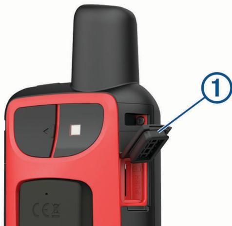
2 Insérez la carte mémoire dans l'appareil, les contacts dorés orientés vers l'avant de l'appareil.
