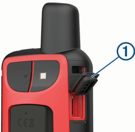
2 Inserta la tarjeta de memoria con los contactos dorados orientados hacia la parte frontal del dispositivo.
