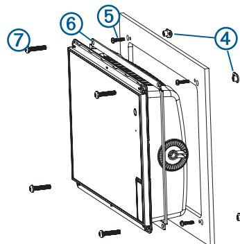
17 小さい穴を小さい小ねじ⑤で締めて、ナットプレートと取り付け面を固定します。
