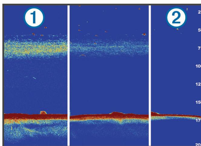
您可以合併使用回音延展和篩選器寬度以獲得較好的解析度，同時降低雜訊。在將回音延展和篩選器寬度皆設為低的情況下，顯示會具有最高解析度，但也最容易受到雜訊影響。在將回音延展設為高而篩選器寬度設為低的情況下，顯示會具有較低解析度，但也具有較寬的目標。在將回音延展和篩選器寬度皆設為高的情況下，顯示會具有最低解析度，但也最不容易受到雜訊影響。不建議將回音延展設為低而篩選器寬度設為高。
