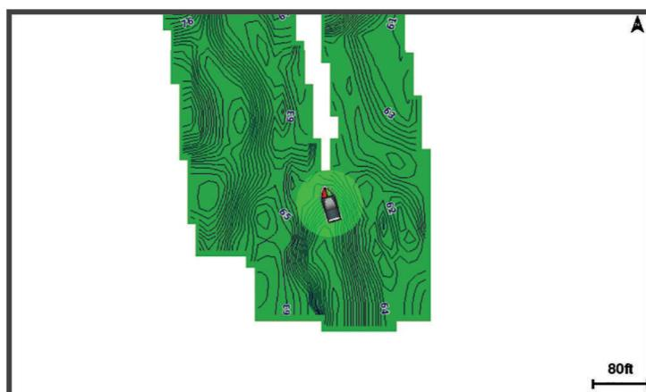
綠色圓圈表示良好的深度和 GPS 位置，且速度低於 16 公里/小時 (10 英哩/小時)。黃色圓圈表示良好的深度和 GPS 位置，且速度介於 16 和 32 公里/小時 (10 和 20 英哩/小時)。紅色圓圈表示不良的深度或 GPS 位置，且速度超過 32 公里/小時 (20 英哩/小時)。
