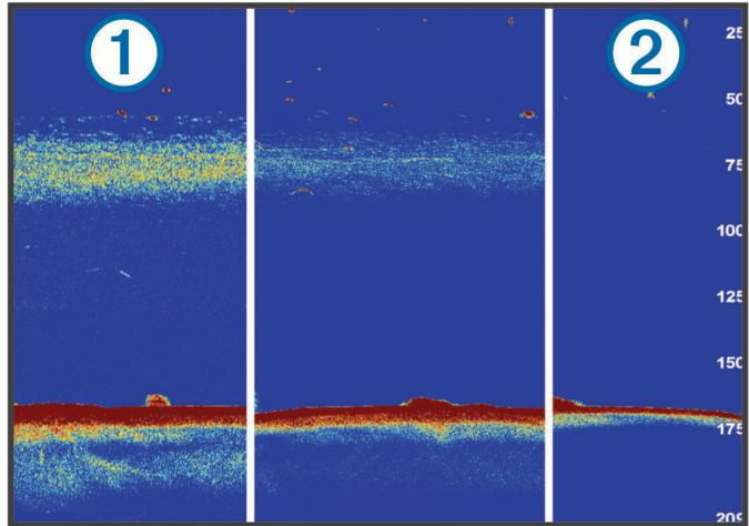
에코 길이와 필터 너비를 함께 사용하여 원하는 해상도와 잡음 제거 효과를 얻을 수 있습니다. 에코 길이와 필터 너비를 낮음으로 설정하면 디스플레이 해상도는 높지만 잡음에는 취약해집니다. 에코 길이를 높음으로 설정하고 필터 너비를 낮음으로 설정하면 디스플레이 해상도는 낮아지고 타겟 너비는 커집니다. 에코 길이와 필터 너비를 높음으로 설정하면 디스플레이 해상도는 낮지만 잡음에는 강해집니다. 에코 길이를 낮음으로 설정하고 필터 너비를 높음으로 설정하지 않는 것이 좋습니다.
