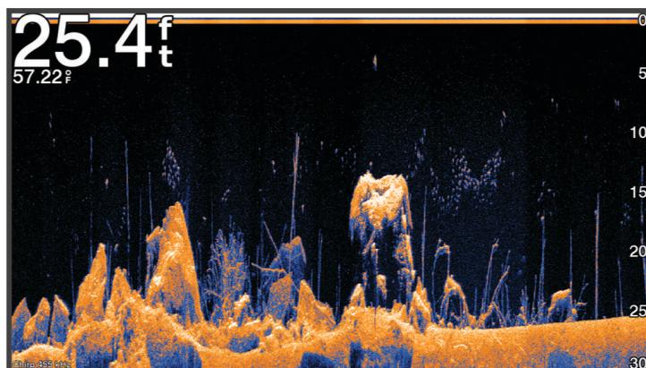
I trasduttori tradizionali emettono un fascio conico. Il sonar Garmin ClearVü che scansiona il fondale emette un fascio simile alla forma del fascio in una fotocopiatrice. Questo fascio fornisce un'immagine più nitida e verosimile di quanto è presente sotto l'imbarcazione.
