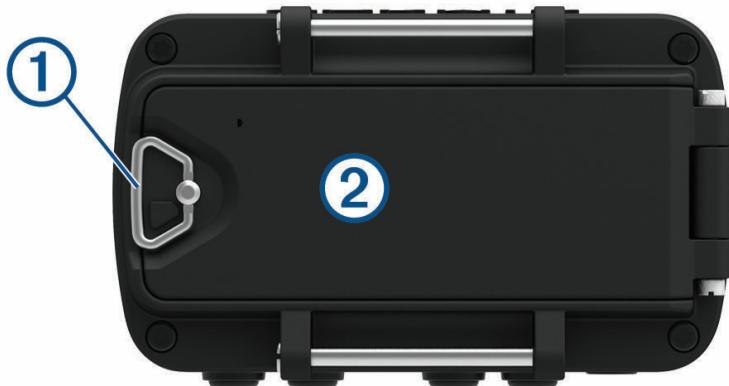
**①** Anello di apertura e chiusura della batteria
