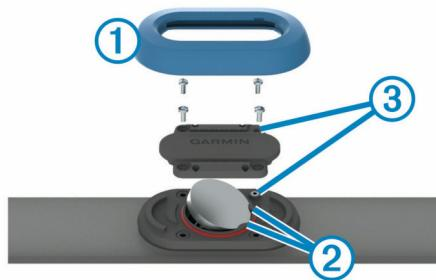
**2** Rimuovere le quattro viti sulla parte anteriore del modulo con un cacciavite Phillips piccolo (00).
