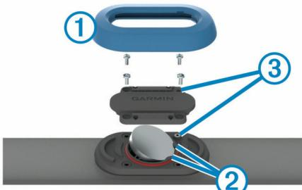
**2** Utilisez un petit tournevis cruciforme (00) pour retirer les quatre vis à l'avant du module.
