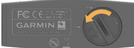
2 Utilisez une pièce de monnaie pour tourner le cache dans le sens inverse des aiguilles d'une montre jusqu'à ce qu'il soit suffisamment desserré pour pouvoir être retiré (la flèche doit pointer sur la position OPEN).
