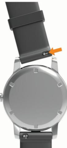
**2** Setzen Sie eine Seite des Federstegs für das neue Band in das Gerät ein.
