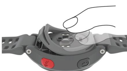
Уплотнитель должен прилегать к задней панели устройства без зазоров.
