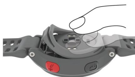
Não devem existir espaços entre o bloqueio de luz e a parte traseira do dispositivo.
