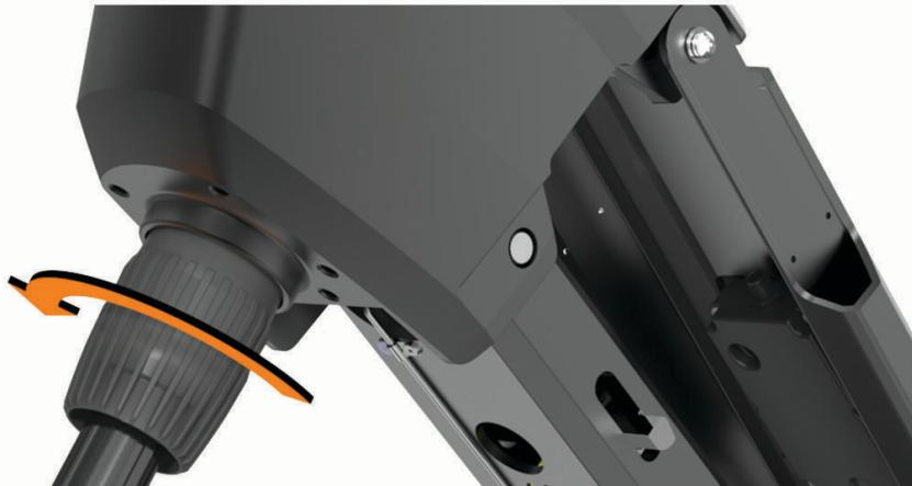
**NOTA:** debes estar preparado para que el motor se deslice hacia abajo al aflojar el collarín.
