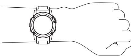
**REMARQUE :** le capteur de fréquence cardiaque est situé à l'arrière de l'appareil.
